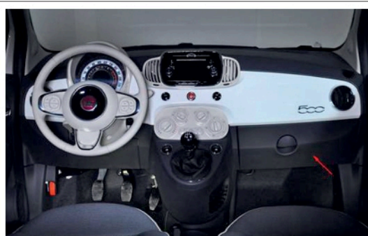
Fig. 12: Vano portaoggetti, da produrre in injection molding, con il polimero termoplastico di recupero
