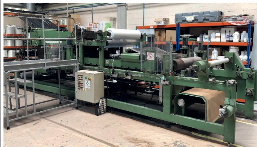
Fig. 1, 2 e 3: Linee pilota per la produzione di prepreg presenti in Gaiker (double laminator, SMC e calandra)
