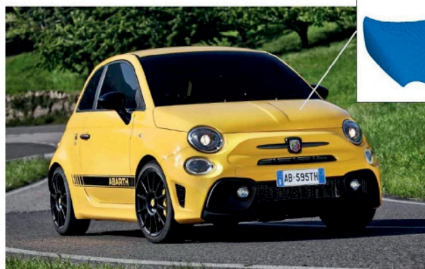
Fig. 11: Cofano da produrre in composito totalmente riciclabile, secondo la nuova tecnologia
