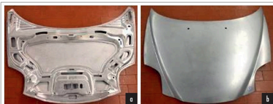
Fig. 4 a, b: Cofano attuale in lamiera, da sostituire con corrispondente elemento in composito totalmente riciclabile
