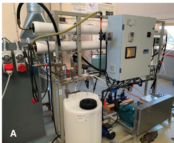
Fig.4: Impianto di dissalazione pilota a osmosi inversa presso il centro ENEA di Casaccia (A), prototipi di pompa e recuperatore energetico per dissalatori (progetto Proof of Concept POC ENEA)
