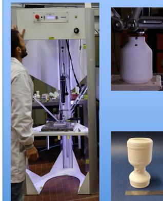
Realizzazione di un gassificatore in tialite da stampa 3D ad estrusione di paste ceramiche sviluppate da ENEA
