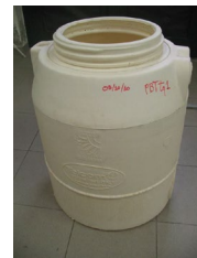
Prototipo di contenitore per liquidi infiammabili in PA6 Nanocomposito
