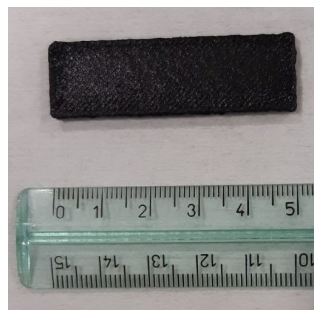
Provino di stampa 3D con il filamento PLA/rCF prodotto
