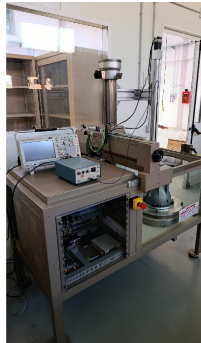
Sistema a 5 assi per controlli ad ultrasuoni motori criogenici
