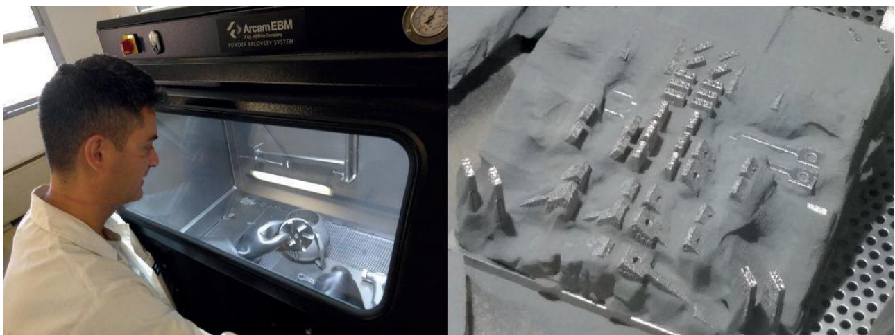
Sabbiatura dei componenti al termine della stampa EBM
