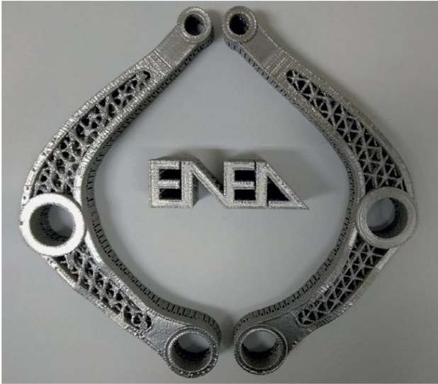
Componenti alleggerite per il settore Automotive e Turbina per settore energetico realizzata in Ti6Al4V
