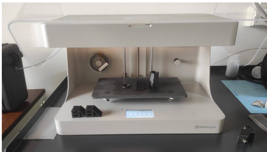
Piano di stampa della Mark Two ("Mark Two ENEA CRC") a fine lavorazione, con provini a pattern reticolare e logo ENEA
