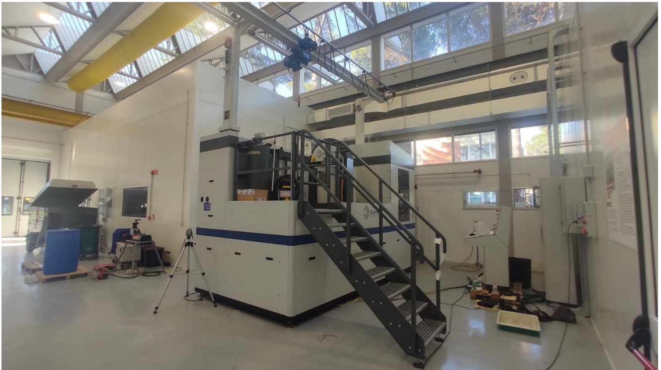
La HIP nella Hall Tecnologica dell'infrastruttura MAIA
